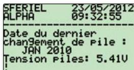
Si on souhaite écrire la date de changement de pile, il faut passer d'abord la commande DLE 0 puis passer la commande DLE 21. Dans ce cas la réponse devient :
