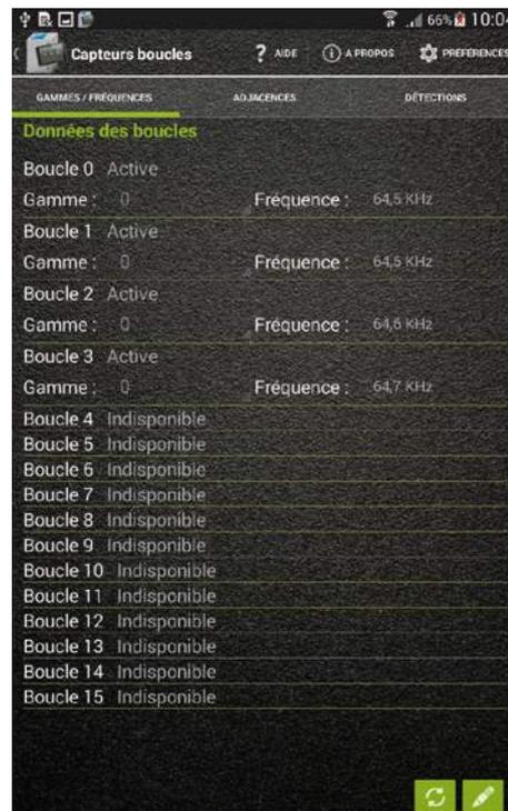
Dans l'exemple ci-dessus, la station est équipée de quatre boucles et celles-ci n'ont pas été configurées : chaque boucle utilise la gamme 0. Il faut donc attribuer une gamme de fréquence à chaque boucle en respectant les principes suivants :
