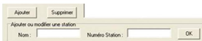
La modification d'une touche de commande préprogrammée se fait par un clic droit sur la touche en question. Une fenêtre s'ouvre alors qui permet de modifier le nom et le texte de la commande. L'appui sur le bouton OK valide la modification.
